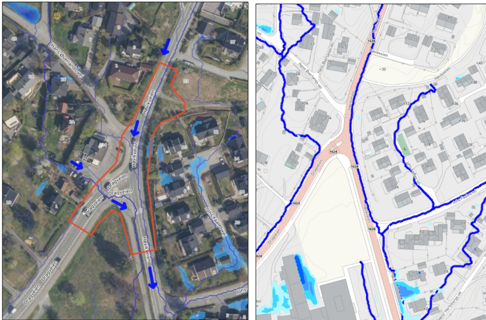
Figur 8 Dagens avrenning ved tiltaksområde. Til venstre - modellering av avrenning i Scalgo (SCALGO Live, 2024), til høyre - aktsomhetskart sekundære flomveier (Bærum kommune, 2024)
